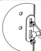
7º Parafuse o conector 2 na porta como segue a imagem ao lado. Fixe com parafuso M4x6mm.
