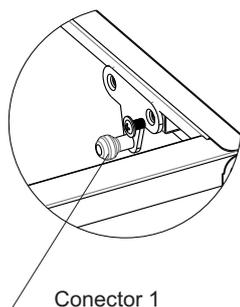
4º Encaixe a lateral (LAE) na base (TB), (já posicionada sobre as costas) fixe com parafuso M4x6mm e porca M4.
